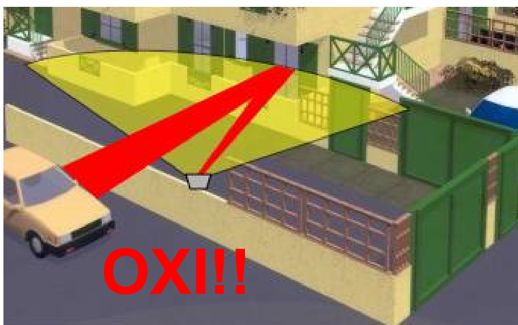
Σχ. 4 Αποφύγετε να έχετε τις δέσμες να βλέπουν σε αντανακλώμενες επιφάνειες
